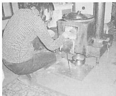
旧型（左図）は側面から、新型（右図）は上から石炭を投入
